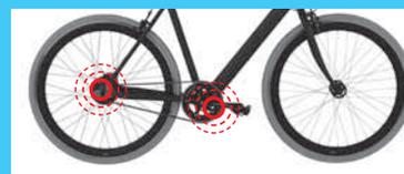
Der **in den Hinterbauständer integrierte Drehmomentsensor** bietet **höchste Präzision** und sorgt für leistungsstarke, ruckfreie und reaktionsschnelle Unterstützung. Mit „Zero Reset Function“ zur Selbstkalibrierung des Sensors.
