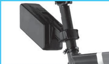
Der **kompakte, leichte 250Wh-Akku aus Samsung-Zellen** ist in einem **kleinen Anbau an der Sattelstütze** untergebracht.
