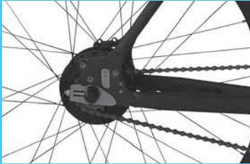
Leistungsstarker 250W-Heckmotor mit 75 - 82% Wirkungsgrad, hohem, konstantem Drehmoment, 432W Spitzenleistung und 25 km/h Höchstgeschwindigkeit.
