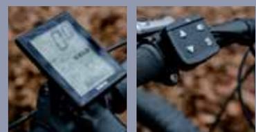
Das Yamaha PW-X Display verfügt über Bluetooth-Konnektivität, wodurch sich das System mit Sport-Apps wie Strava oder Runastic verknüpfen lässt.
