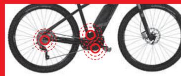
Die vollkommen in das Motormodul integrierten Drehmoment- und Taktsensoren der Bosch-Reihe bieten höchste Präzision und sorgen für leistungsstarke, ruckfreie und reaktionsschnelle Unterstützung.
