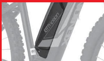
Der Lithium-Ionen-Akku Powerpack von Bosch (400 oder 500 Wh) ist vorderen Rahmendreieck integriert und ermöglicht eine Reichweite von bis zu 105 km (500Wh-Akku Standard) bzw. 85 km (400Wh-Akku Lite)\*.
